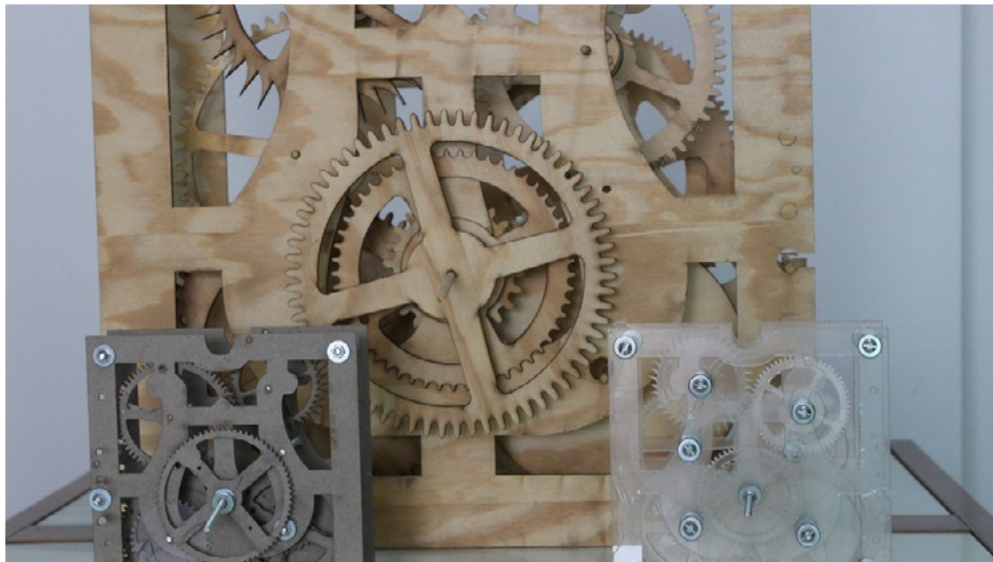
Figura 1: Detalhe de diferentes materiais cortados a partir de modelo digital, 2024, Miguel Alonso.
